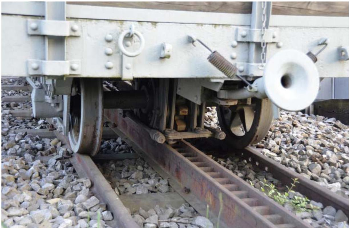
Blick unter den Wagen: Deutlich ist die Zahnradbremse zu erkennen.
